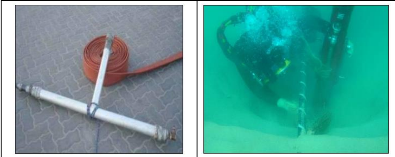
Figura 4 e 5: Ferramentas de mergulho para enterramento
